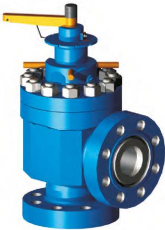
Кран дросельный предназначен для установки в устьевой арматуре для регулирования режима работы скважины посредством замены одного диаметра дросселя (штуцера) на другой без остановки работы скважины.
